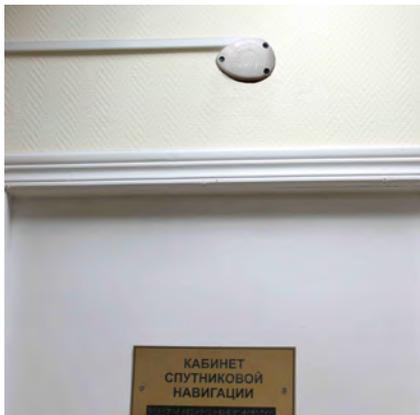
Ориентир получает по радиоканалу от Оборудования, находящегося в зоне его действия, и воспроизводит сообщение об объекте, на котором Оборудование установлено.
